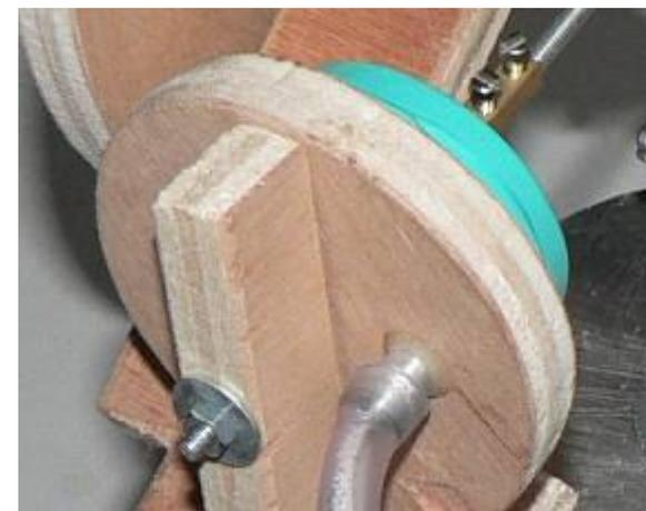
→ le tube d'aluminium phi=6 est collé à l'araldite
