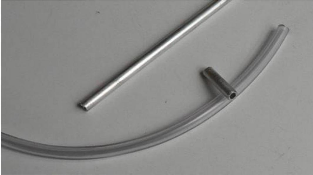
→ Du tube d'aluminium de 5 mm et un tuyau plastique permettent de relier le cylindre déplaceur au piston membrane
